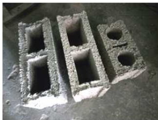
Fabricació de "Blocs Awasuka" i proves de càrrega, comparant entre blocs locals i blocs Awasuka.
